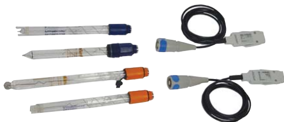
Кабели измерительного преобразователя с различными электродами
